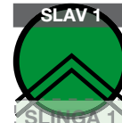
"SLAV 1" Indikerar vilken slavenhet detektorslingan tillhör.
